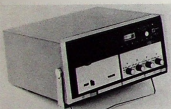
Kompakt-Kassetten-Analog-Magnetbandgerät „Mini Log 4“
