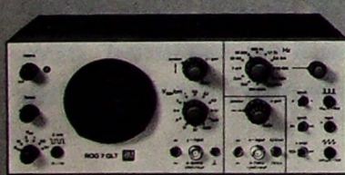
Gleichspannungs-Breitband-Kleinschwinglograf -ROG 7 GLT-
