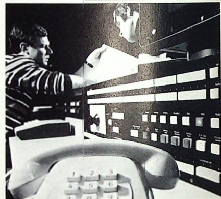
Über den Bedienungsplatz und die angeschlossenen Datenterminals hat das Bedienungspersonal unmittelbaren Zugriff zum Zentralsteuerwerk des „EWS 1“. Bei Inbetriebnahme der Vermittlungsstelle dient der Bedienungsplatz beispielsweise zum Laden der Speicher mit Programmen und Daten
